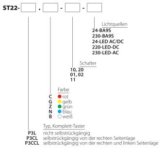
Bezeichnung der Schalter - die erste Zahl ist die Anzahl von Schließkontakten, die zweite Zahl ist die Anzahl von Öffnerkontakten.
