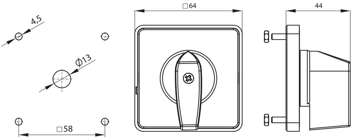
Abstand von Befestigungen 58 mmx58 mm (4 Schrauben M4x18 + 4 Muttern M4)
