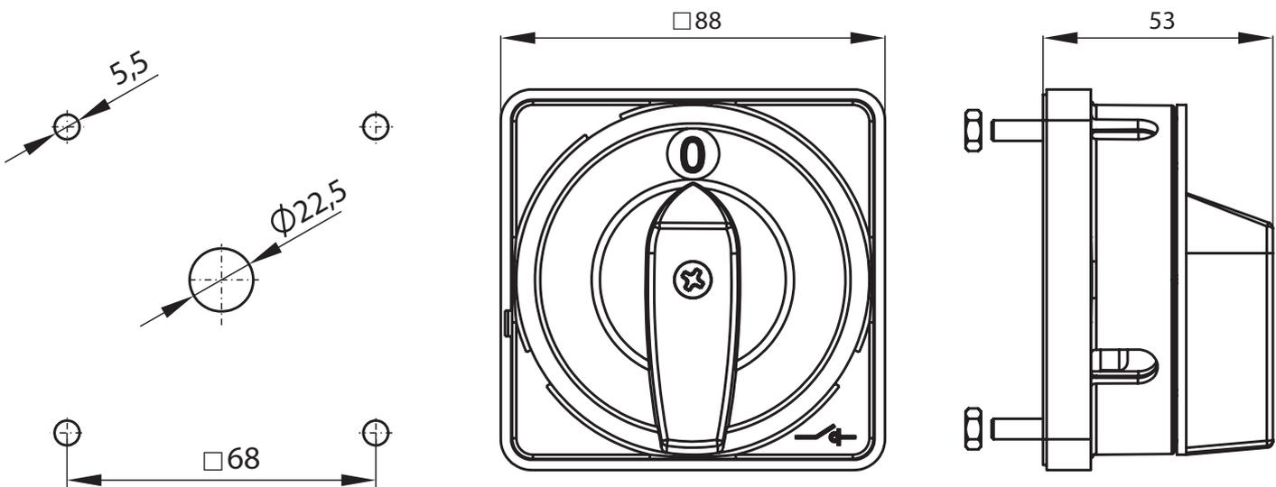
Abstand von Befestigungen 68 mm x 68 mm (4 Schrauben M5 x 20 + 4 Muttern M5)
